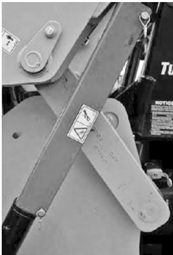
Dispositivo de soporte en una máquina utilizada para movimiento de tierra.
